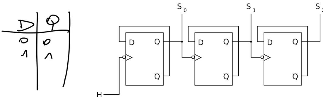
FIGURE 2 – Schéma du séquenceur sans entrée asynchrone
