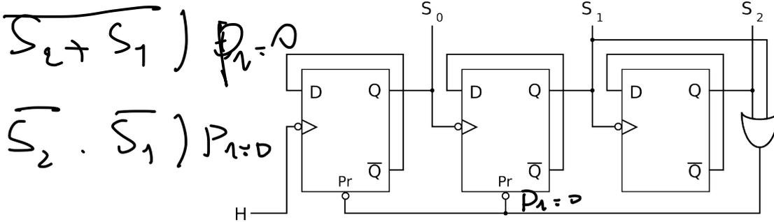
FIGURE 3 – Schéma du séquenceur avec entrée asynchrone
