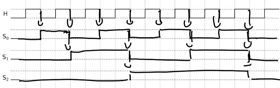
2. Fonction réalisée par le montage de la figure 2 : *diviseur de fréquence par 2*
