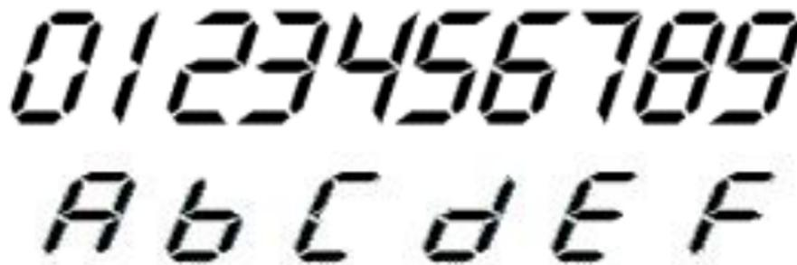
FIGURE 2 – Chiffres et lettres de l’afficheur
